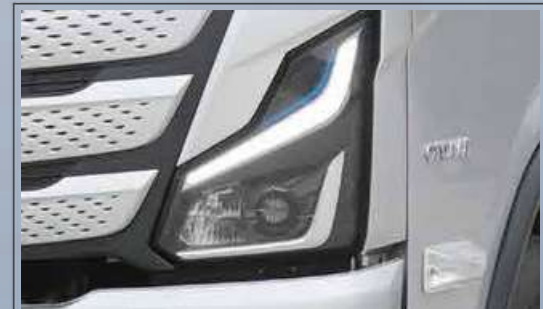
3 configuraciones de iluminación, interruptor de luces automáticas y luces auxiliares laterales
